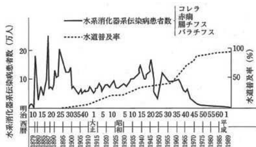
水道普及率と水系伝染病患者数の推移 (出典 改訂 水道のあらし 日本水道協会)
